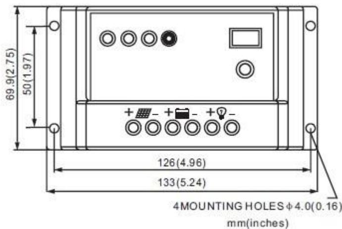
2. 连接系统部件：如下图按顺序连接蓄电池正负极，控制器会自动识别电池电压后开始工作。如果是 12V 的系统数码管显示“12”，如果是 24V 的系统数码管显示“24”。再按顺序连接太阳能光伏板正负极，如果有阳光，充电指示灯会亮，否则检查连接是否正确，最后连接负载正负极，完成连接。
